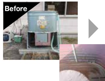
練習場ボール洗球機（2016年製造） 回転ブラシが回りにくく、水槽内に入れた水が漏る状況
